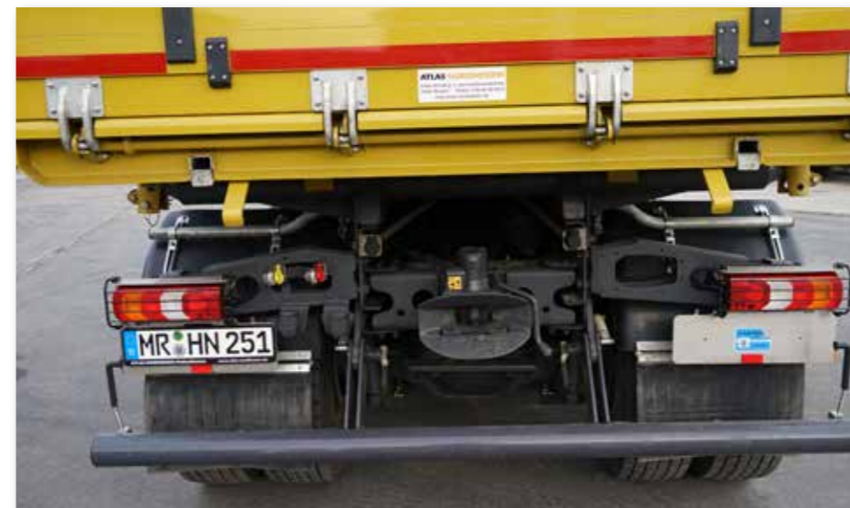
Je zwei oberhalb der Achsen angebrachte Sensoren messen den Abstand zum Boden und errechnen daraus die aktuelle Fahrzeugneigung.
