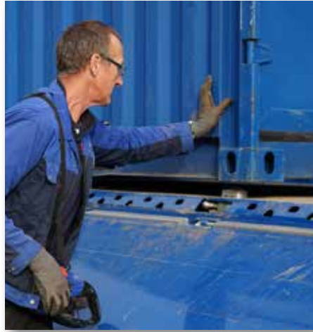
Dank der Twistlocks spart der Fahrer bei jedem Containertransport rund zehn Minuten Zeit.
